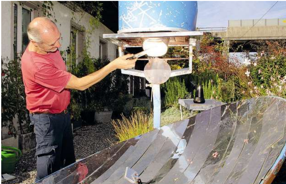
Alec Gagneux am Solarkocher. Im Einfangen und Bündeln des Sonnenlichtes durch den Parabolspiegel entsteht eine Hitze von bis zu 700 Grad Celsius.
